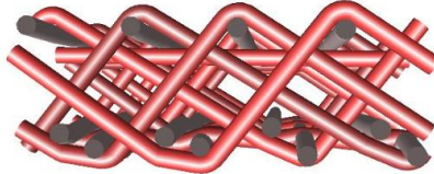
Obr. 1 Podélný řez – vícenásobná tkanina s provázáním vazné osnovy pod úhlem
